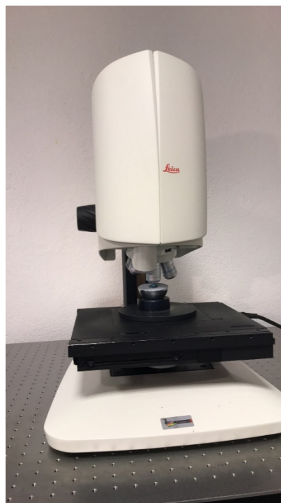
Fig. 4. Microscopul confocal Leica DCM8 al laboratorului PALEVOPRIM
